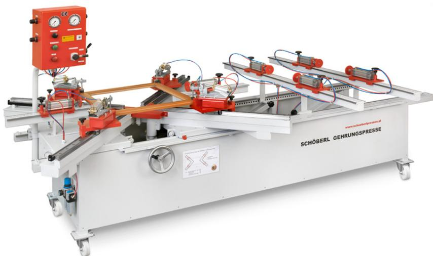
Die Schöberl Gehrungspresse ist auf Wunsch mit Einlegepresseseinheiten für den Druck von der Seite, mit einer Winkelverstellung für nicht-rechtwinkelige Gehrungen sowie in schräger Ausführung lieferbar.
